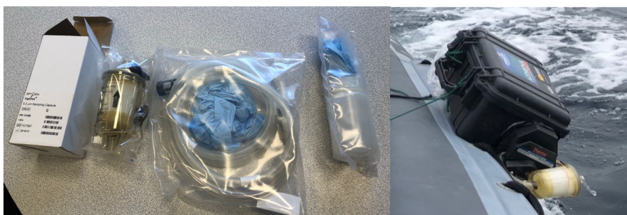
Figure 1 : A gauche : consommables utilisés pour filtrer l'eau de mer et collecter l'ADNe : filtre, tuyau, tampon d'extraction. Tous les consommables sont conditionnés stérilement, tous sont à usage unique. A droite : Pompe Athena en cours de filtration lors d'un prélèvement.
